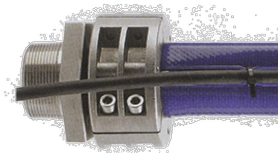
Dieser Trinkwasser - Flachschauch ist innen und außen aus thermoplastischem Polyurethan gefertigt. Für die Verwendung als Tiefbrunnenschlauch mit aufvulkanisierten Schlaufen zur Kabelbefestigung ausgerüstet.
