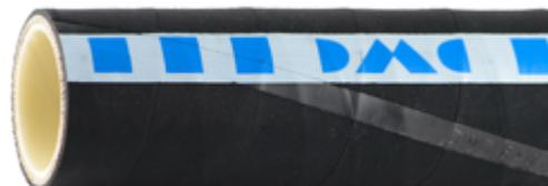
Chemieschlauch mit UPE / UHMPE Seele, nach EN 12115. Einsatzzweck als Lösungsmittelschlauch, Säureschlauch, Lösungsmittel-Schlauch oder allgemeiner Chemikalienschlauch nach Medienliste EN 12115. Weiterhin geeignet als Lebensmittelschlauch für flüssige Lebensmittel. Mit FDA Spezifikation Title 21 CFR 177.1520 (Olefin-Polymere).
